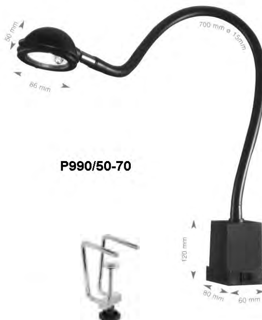
P990/50-70 lampada alogena a stelo lungo flessibile luce diffusa – 20W 12v stelo da 50 o 70 cm fissaggio con viti o con morsetto opzionale CLAMP03 lampadina art 4/C
